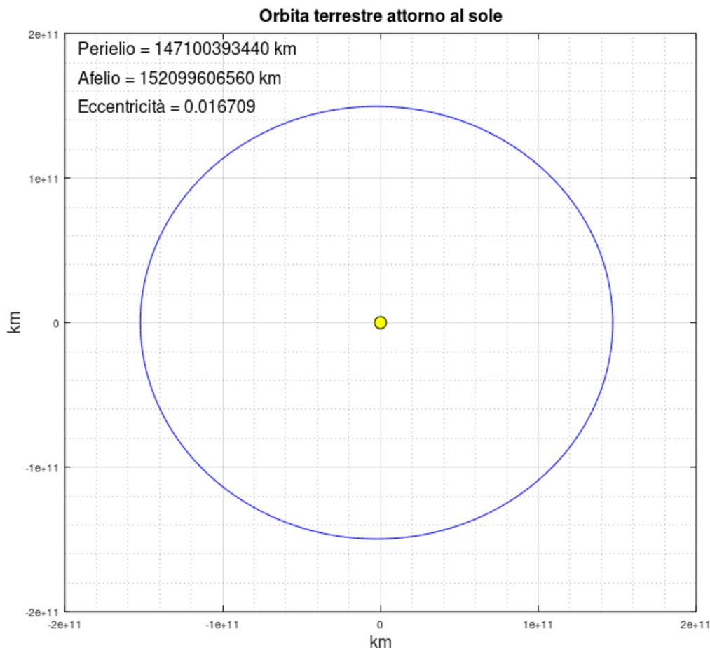
Come secondo esempio applicativo dell'equazione di Kepler calcoliamo il bilancio energetico-meccanico di un corpo celeste (di massa  $m$ ) orbitante attorno ad un corpo centrale di massa  $M$ , dove sia  $M \gg m$ .
